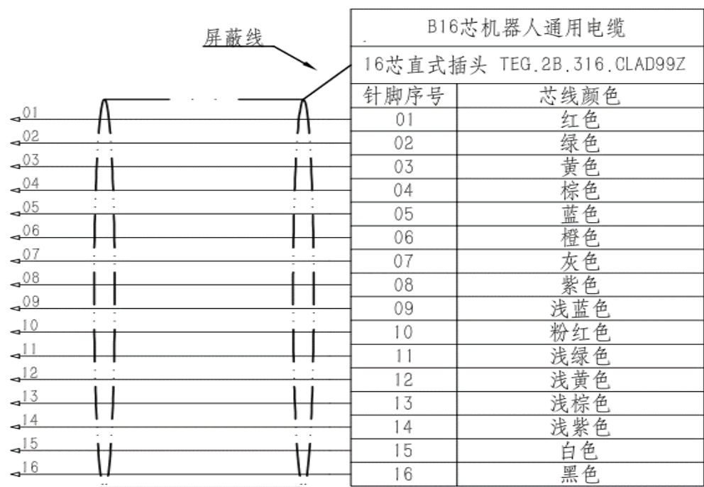
图 4-8 第二机械臂 CS 接线图
