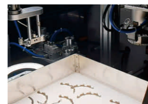
电机骨架柔性组装
