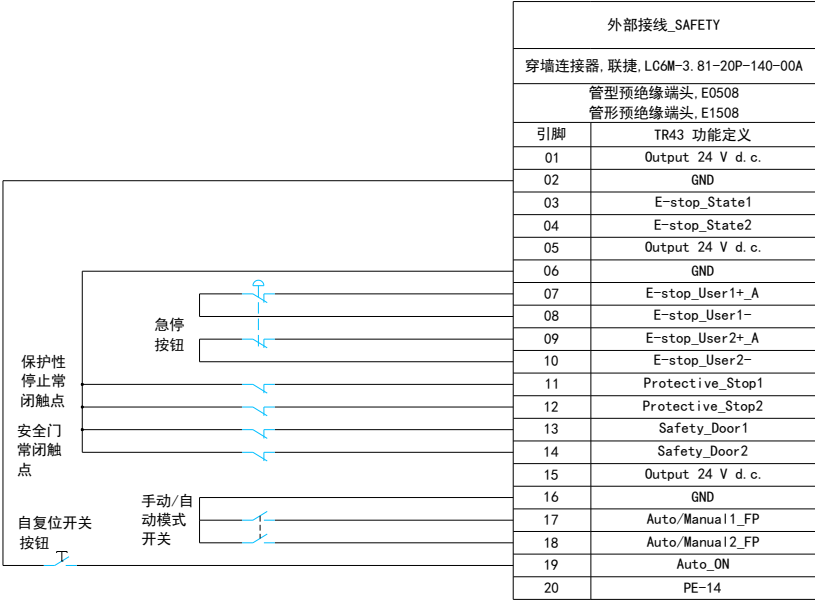
图 1 数字安全输入典型接线图
